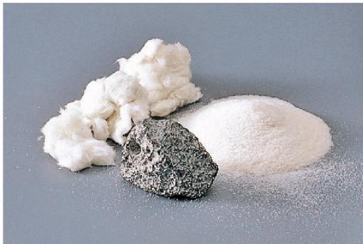
采用大建自主研发高性能材料“DAILITE”，原料为防火矿物纤维与火山玻璃质堆积物。
